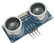
■ 左方的是模組的超聲波發射器，而右方的為超聲波接收器。
