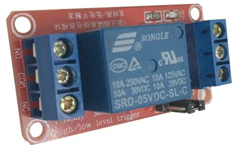
■ 繼電器連接至Arduino的一端。IN接口需連接至Arduino其中一個數位輸出，而DC+ 及DC- 分別連接至Arduino的5V輸出及接地（GND）接口。
