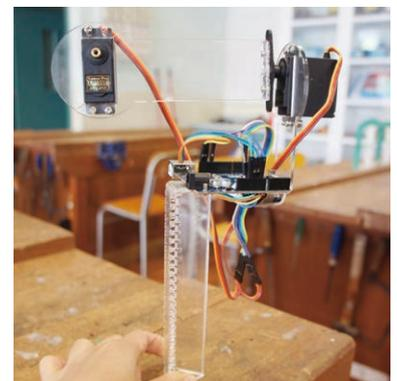
運用各項元素，可製作機械人外，也可設計生活智能用品，如圖中手機三軸穩定器，2 個 Servo 和 Arduino 底板，並配合程式就可以。
